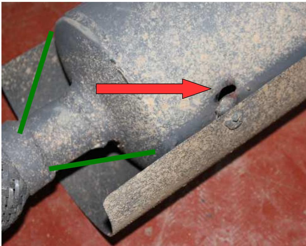
Il faut aussi demonter la plaque de tole de protection car elle vibre et casse la fixation.
