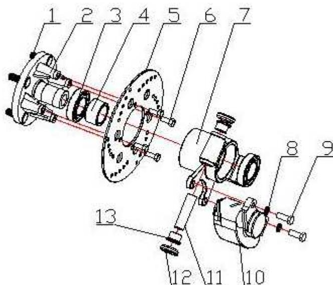
4x SKF 6007-C3 double étanchéité haute vitesse aux roues avant (2 par coté)
