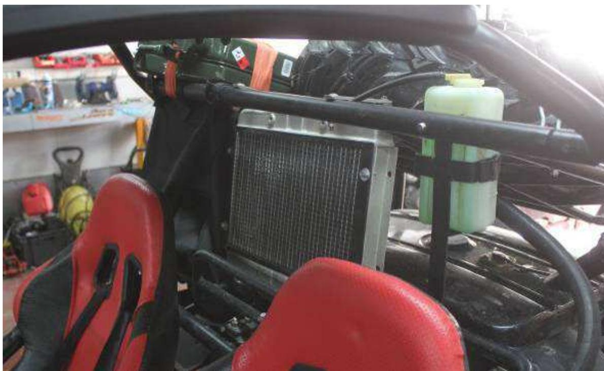
Il est nécessaire de vérifier le branchement de la sonde sur le radiateur régulièrement. En cas de forte vibrations, mettre une cose directement du fil à la sonde en supprimant la connectique existante.
